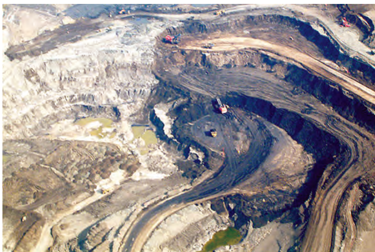
Photo 1. Vue aérienne de la zone d'extraction à ciel ouvert de la société Sunycrude (région de Fort Mac Murray). L'excavation d'une centaine de mètres de profondeur a été réalisée après avoir rasé la forêt boréale (cliché de Chris Evans © 2005 The Pembina Institute. Reproduit avec l'aimable autorisation du Pembina Institute. www.pembina.org )
