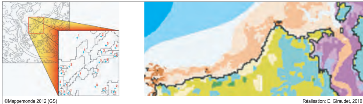
4. Exemple de trait de côte « crénélé » (trait noir), issu de la vectorisation des objets extraits par traitement d'images satellitaires (source: Cuq et al., 2001)
